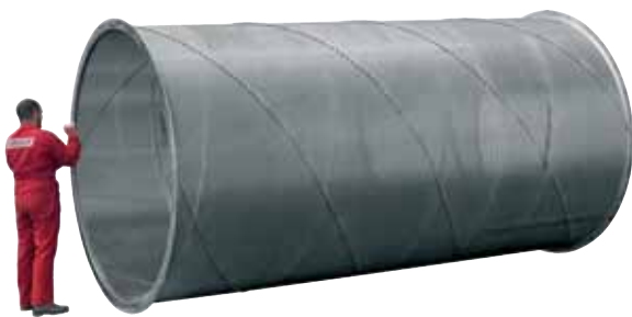
Filtertrommel für einen Durchfluss von innen nach außen, Zufuhr innen
