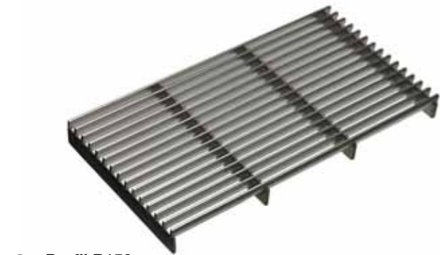
Profil B150 Abstand 4 mm / Träger 10 x 2 mm - Achsabstand 50 mm
