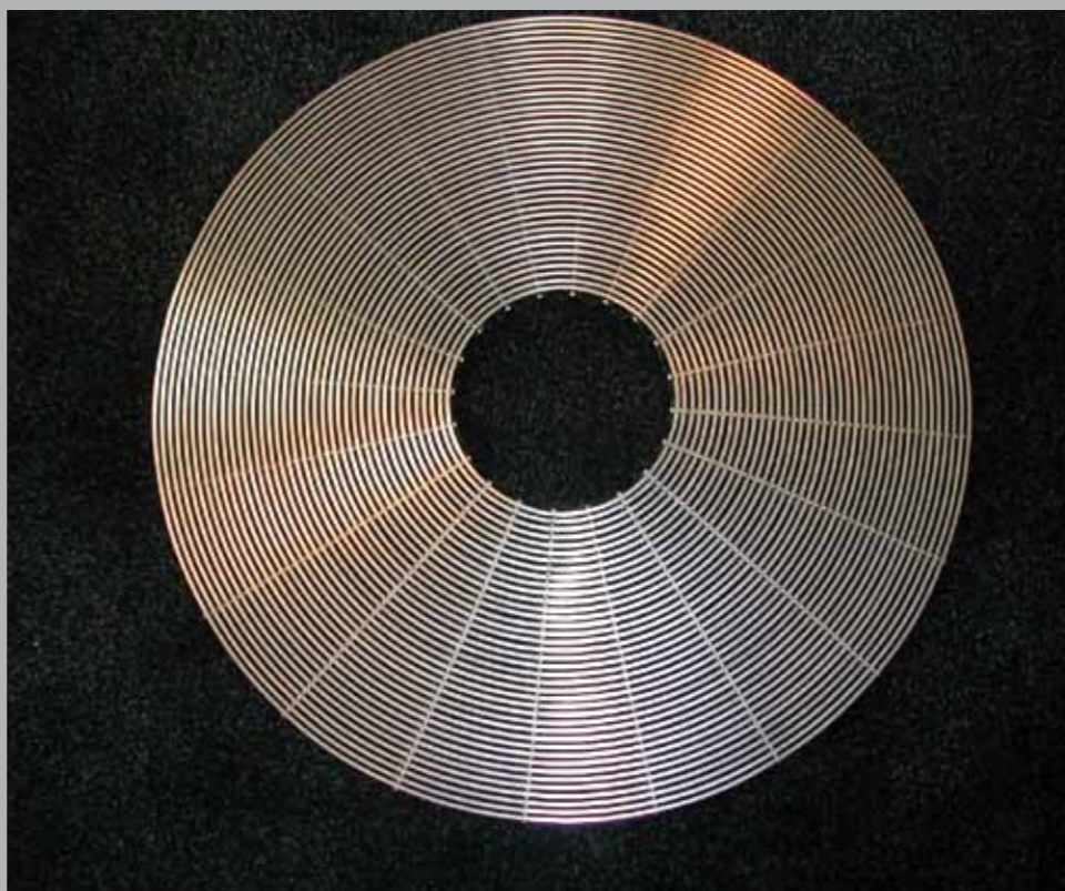
Konstruktion aus gebogenem Draht Profil 10 x 3 mm - Abstand 3 mm - Träger 15 x 2 mm - Achsabstand 75 mm
